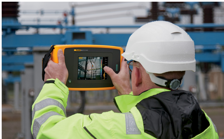
Ảnh chụp Máy chụp ảnh sóng âm chính xác ii910 phát hiện phóng điện cục bộ trong ứng dụng điện áp cao.
